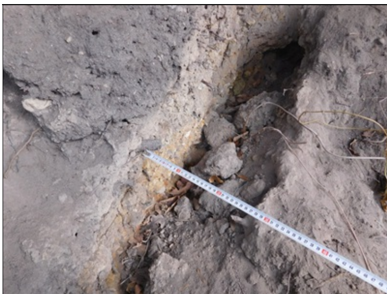
Detail tahové trhliny ve svahu.
